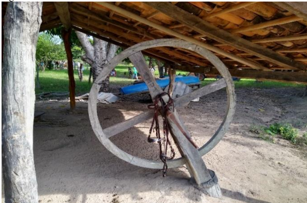
Figura 66: Bolandeira de uma casa de farinha desativada
